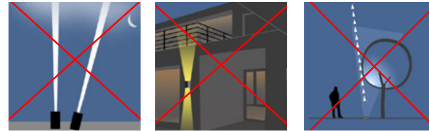
Uplights und Sky-Beamer sind unzulässig, da sie direkt zur Himmelaufhellung beitragen.
